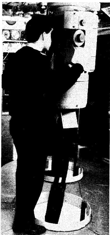
Рис. 3. Окулярный блок перископа IMS-1 ВМС Дании
